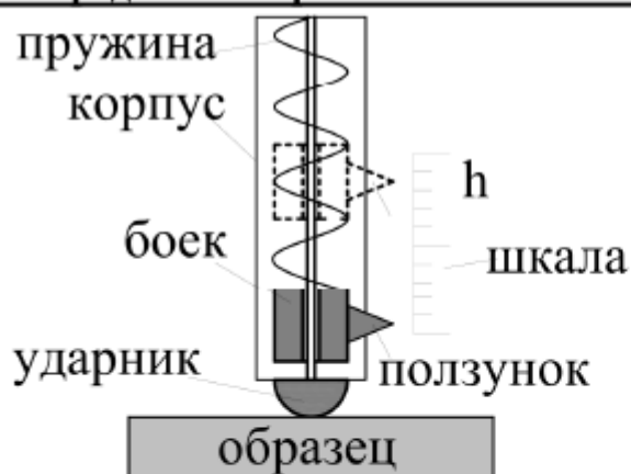
Рис.6.3 Принципиальная схема метода упругого отскока
